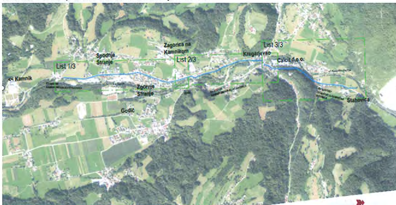
Slika 6.2: Prikaz predvidene trase rekonstrukcije vodovoda
